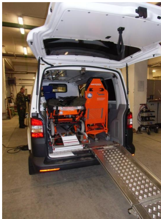
Obr. 3 a 4: Zkouška nakládání a AZS s naloženými nosítky a zdravotnickým křeslem
