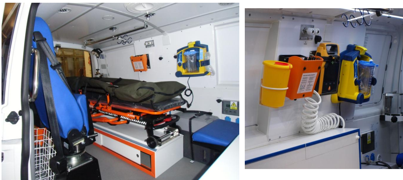
Obr. 5 a 6: Interiér AZS s přepravním lehátkem a přístrojovým vybavením
