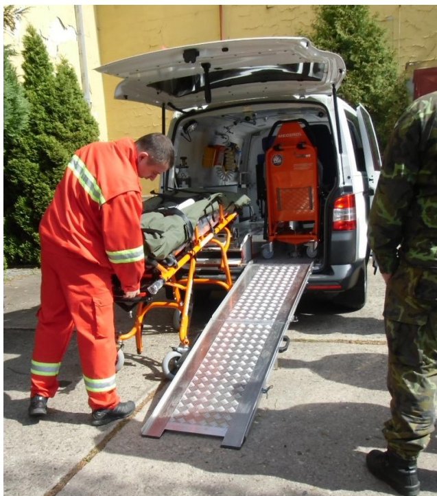
Obr. 3 a 4: Zkouška nakládání a AZS s naloženými nosítky a zdravotnickým křeslem
